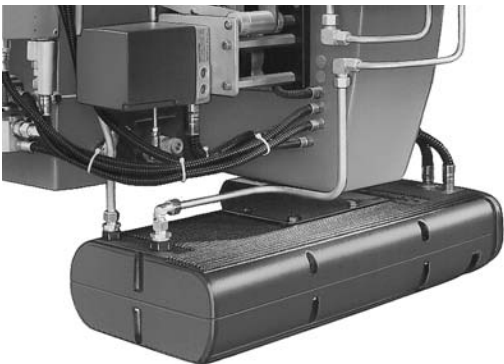
Станция подогревателя теплоносителем
