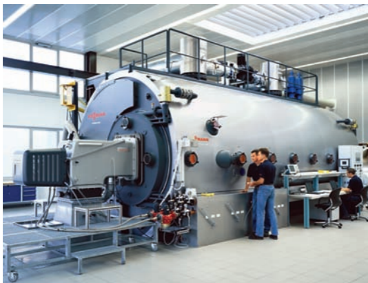
Испытательный стенд – разработка горелок до 32 МВт
