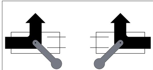
Рис. 4. Двухходовой клапан
