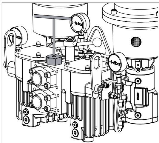
Рис. 7. Настройка внутреннего клапана поддержания давления
