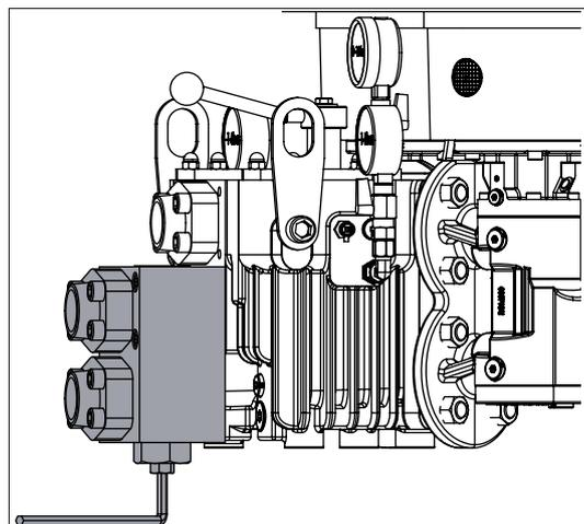
Рис. 8. Настройка внешнего клапана поддержания давления
