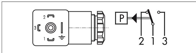
Рис. 2. Подключение пневмовыключателя
