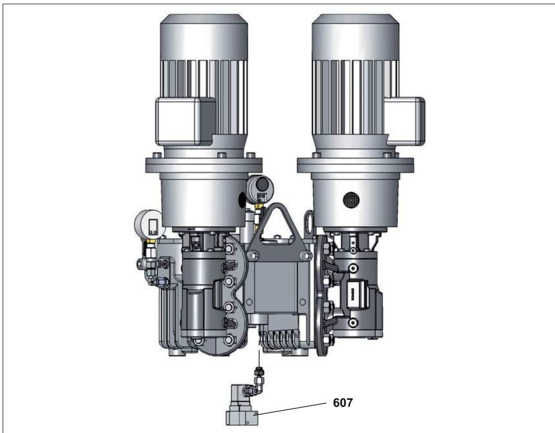
Рис. 9. Пневмовыключатель
