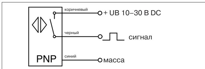
Рис. 1. Подключение концевого выключателя двухходового клапана на стороне всасывания
