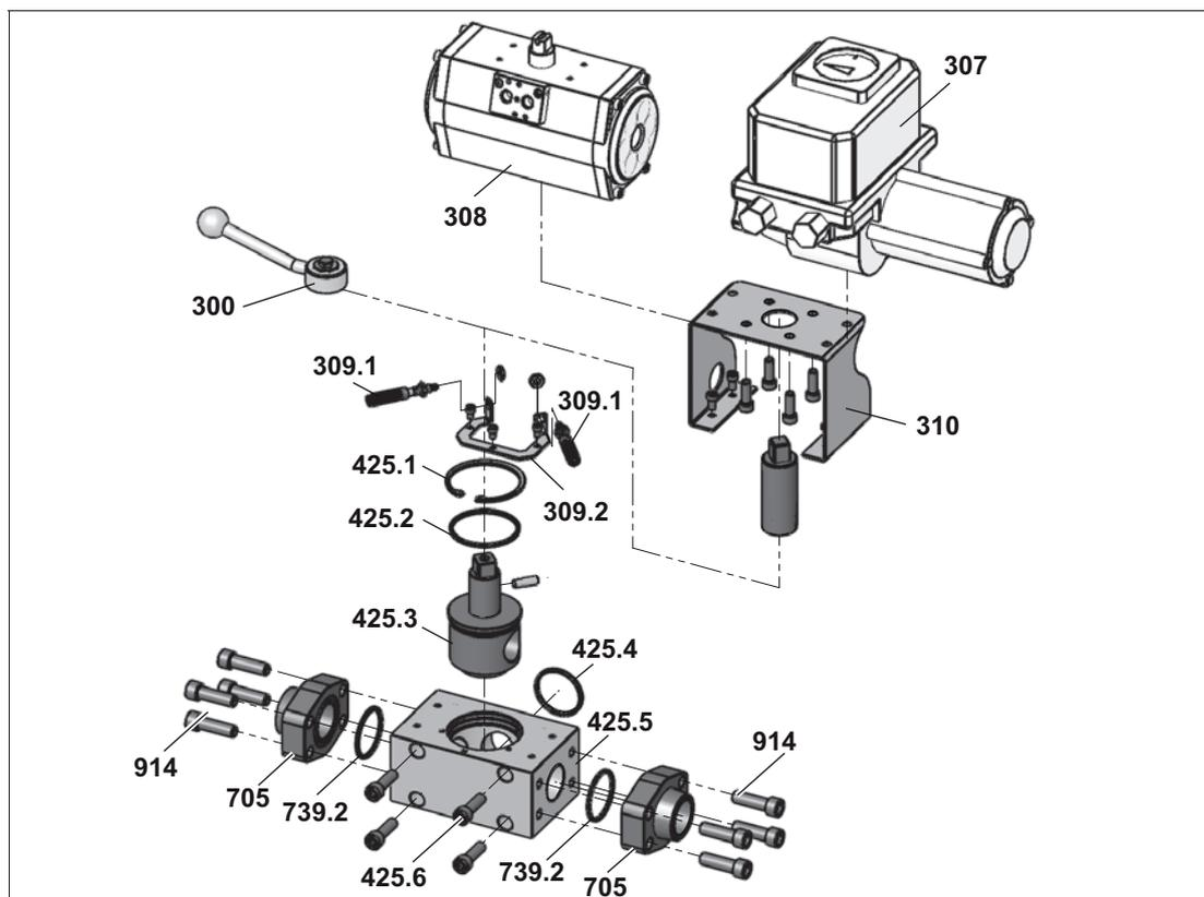
Рис. 7. Двухходовой клапан / концевой выключатель двухходового клапана / сервоприводы
